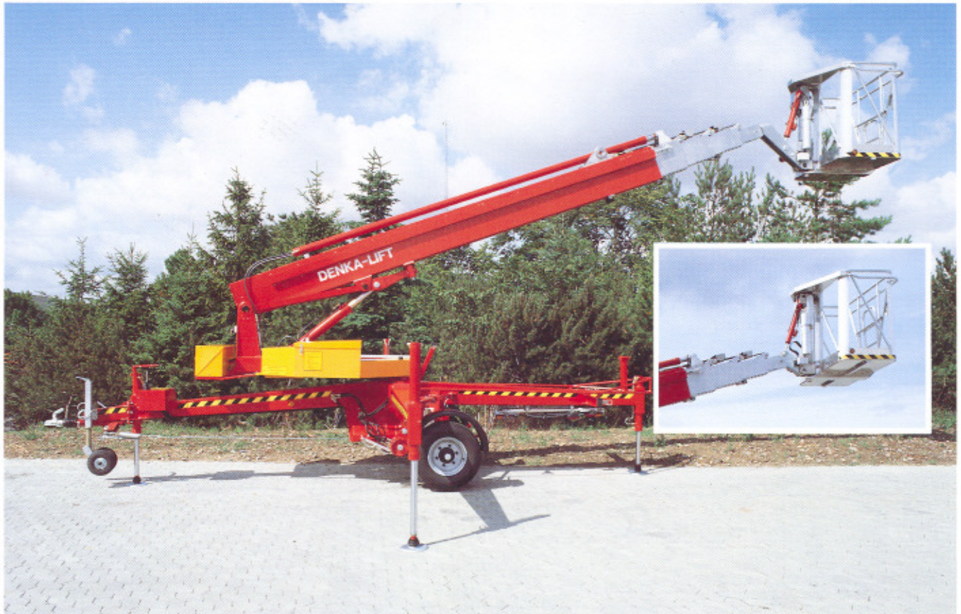
Ein DENKA-LIFT in Arbeitsposition, mit zwei möglichen Korbvarianten und dem hydr. Selbstfahrantrieb.
