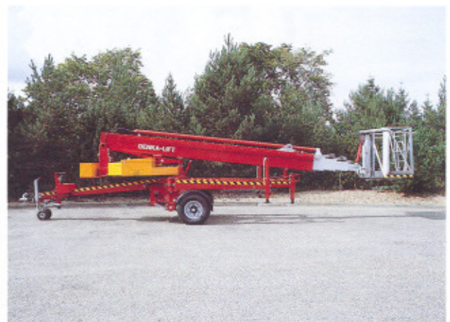
Ein DENKA-LIFT in Arbeitsposition, mit zwei möglichen Korbvarianten und dem hydr. Selbstfahrantrieb.
